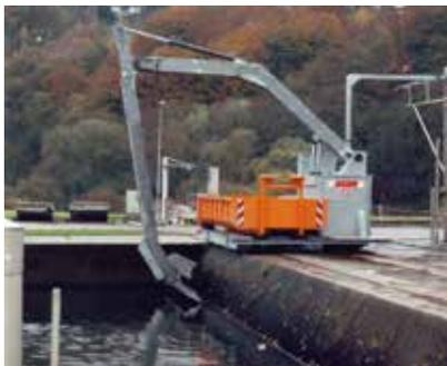
配置有协同移动集装箱的钩臂格栅装置
