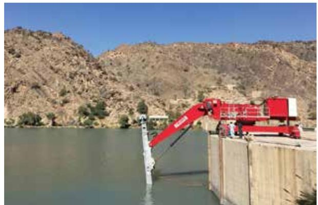
清渣工作中的MUHR移动型钩臂格栅装置
