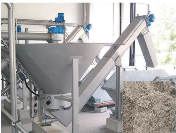
洗砂装置应用于平流沉砂池洗砂分砂处理
